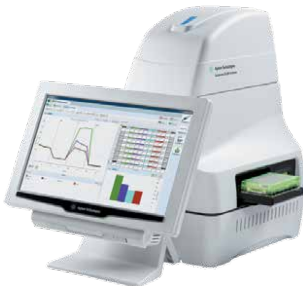
Agilent Seahorse XFe96 Αναλυτής μεταβολικών ροών: Ο αναλυτής μεταβολικών ροών Seahorse μπορεί να μετρήσει τον ρυθμό κατανάλωσης οξυγόνου (oxygen consumption rate, OCR) και τον ρυθμό εξωκυτταρικής οξίνισης (extracellular acidification rate, ECAR) ζωντανών κυττάρων σε πλάκα πολλαπλών φρεατίων.
