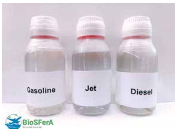
Δείγματα από τα παραγόμενα κλάσματα βιοκαυσίμων
